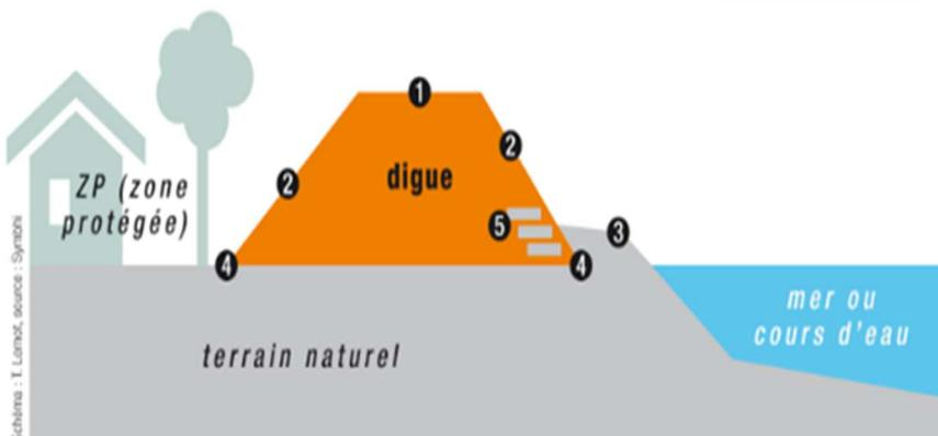
**1** Crête de digue supportant généralement une piste. **2** Talus de digue : talus aval côté ZP, talus amont côté eau. **3** Berge. **4** Pied de digue. **5** Protection anciennes : perré, lauzes...
